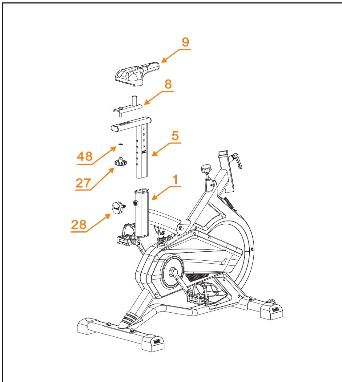
Установите регулируемую стойку (5) в держатель на главной раме (1), отрегулируйте положение детали по высоте и зафиксируйте её, используя ручку (28).
