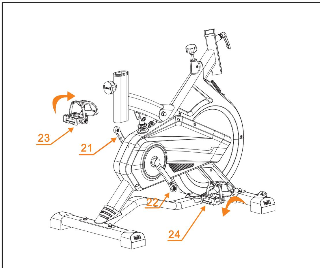
Закрутите левую (23) и правую (24) педали в одноимённые кривошипы (21/22). Начните закручивать педали вручную, а затем, сделав 4-5 оборотов, затяните детали при помощи гаечного ключа.
