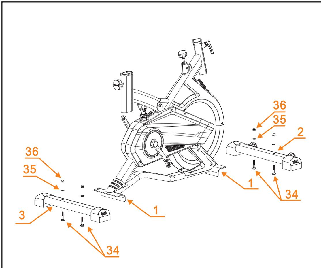
Прикрепите передний (2) и задний (3) стабилизаторы к главной раме (1) при помощи четырёх комплектов крепежей – болтов (34), шайб (35) и контргаяк (36).
