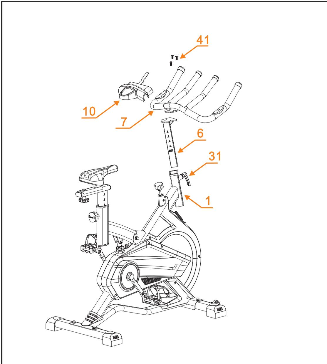
Закрепите поручень (7) на опоре (6) при помощи двух винтов (41). Затем установите опору в главную раму (1), как показано на рисунке, и зафиксируйте конструкцию при помощи ручки (31).
