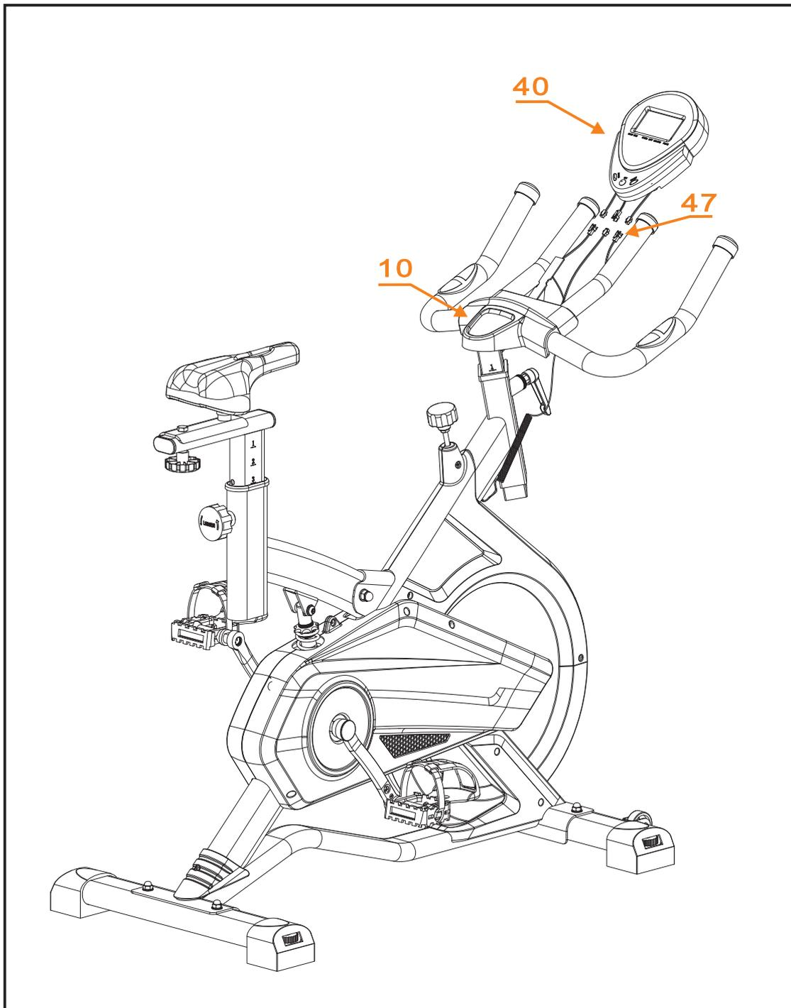
Соедините провода датчиков (47) с проводами консоли (40), как показано на рисунке, после чего закрепите устройство на тренажёре.
